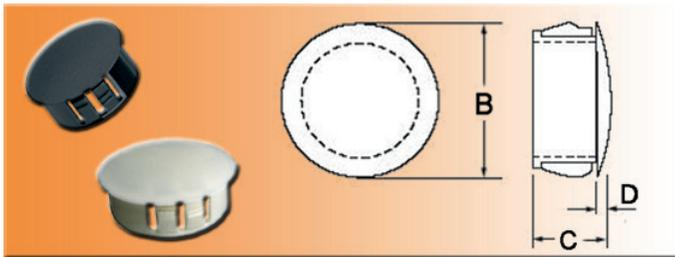
Diese Abdeckstopfen verschließen und decken nicht benötigte Montagelöcher leicht, schnell und kostengünstig ab. Erhältlich in 27 Größen für Montagelöcher von 4,8 - 101,6 mm  $\varnothing$ . Fester Sitz garantiert in Wandstärken bis zu 6,4 mm. Der konvexe Kopf läuft zu einer dünnen Kante aus und bietet eine saubere Abdeckung.
