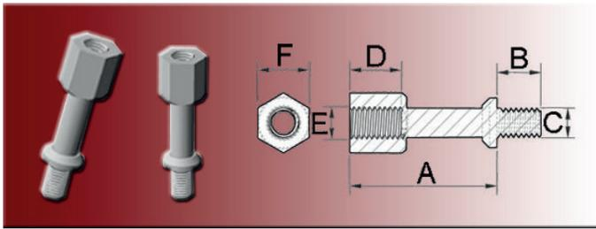
Leiterplattenverbinder, schraubbar - mehrere Leiterplatten können hiermit gekoppelt werden. Mit dem Plattenfuß Typ 139 (Seite 215) ist eine Vormontage von Leiterplattenpaketen möglich. Kann auch mit den Distanzhülsen 005 (ab Seite 238) oder den Leiterplattenhaltern Typ 1001 (Seite 209) kombiniert werden.
