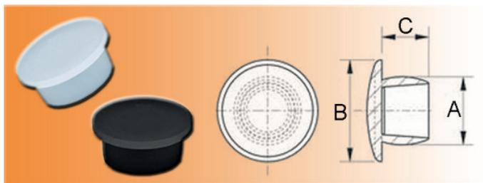
Bitte beachten Sie bei der Auswahl der Zierstopfen, daß der Schaftdurchmesser (A) etwa 0,2 bis 0,3 mm größer sein muß als die zu verschließende Bohrung.
