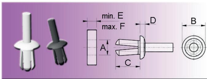
Für eine schnelle Nietverbindung mit Blindmontage.
