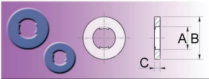
Speziell entworfen um das Verlieren von Schrauben und Bolzen bei der Montage zu verhindern.
