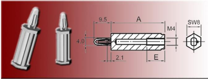
Leiterplattenhalter mit Innengewinde M4, SW8 - schnappbar für Leiterplatten 2,0 mm dick
