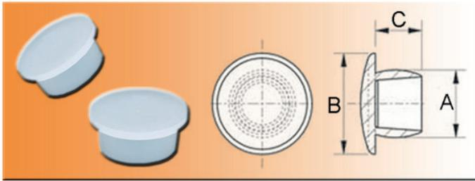
Bitte beachten Sie bei der Auswahl der Stopfen, daß der Schaftdurchmesser (A) etwa 0,2 bis 0,8 mm (je nach Nennmaß) größer sein muß, als die zu verschließende Bohrung.
