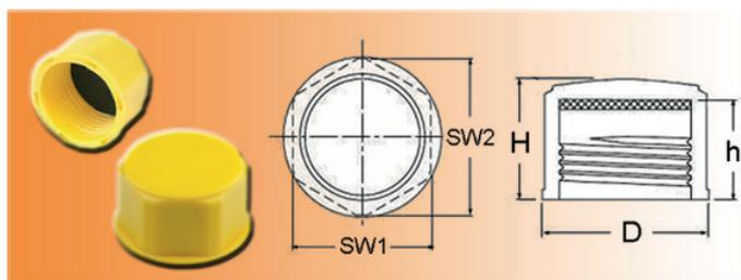
Geringe Abnutzung durch robustes HDPE. Innere Neoprendichtung verhindert das Auslaufen von Flüssigkeiten. Handmontage wird empfohlen! Zusätzlicher Außensechskant, passend für Werkzeug mit niedrigem Drehmoment.
