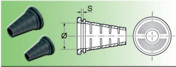
Dieser Typ Kabeltüllen schützt Kabel optimal gegen Abknicken an Gehäusen und Blechen. Ein Universalartikel für Bohrungsdurchmesser von 20 mm. Die Hülse ist abgestuft und zuschneidbar für Kabelgrößen von 8 mm bis 17 mm.
