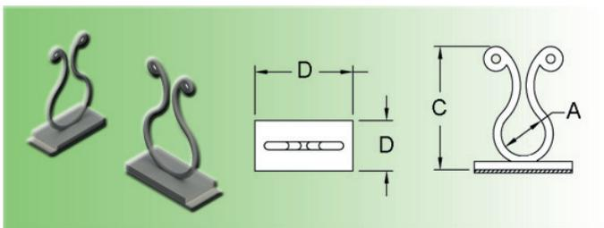
Schnelle und einfache Lösung zum Bündeln und Befestigen von Kabeln. Auch für mehrere Kabel mit unterschiedlichen Durchmessern geeignet.
