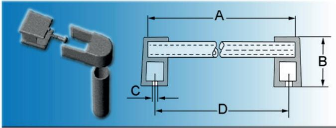
Mit zwei Endstücken und einem Aluminiumrohr ( $\varnothing$  20 mm) können Sie Ihre Handgriffe selbst herstellen.
