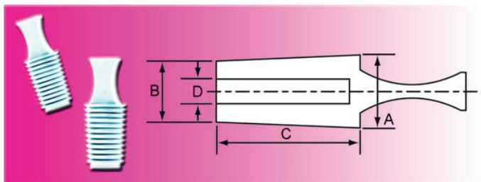
Gerippter Stopfen ohne Flansch. Durch sein konisches Design ist jeder Stopfen für mehrere Gewindegrößen einsetzbar.
