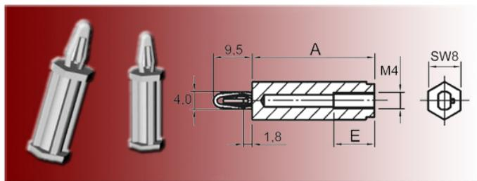
Leiterplattenhalter mit Innengewinde M4, SW8 - schnappbar für Leiterplatten 1,6 mm dick
