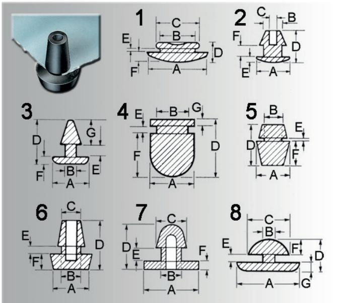
Diese Füße sind zum Einbau in Metall- und Kunststoffgehäusen geeignet und werden einfach per Hand in die gestanzten oder gebohrten Löcher eingedrückt.
