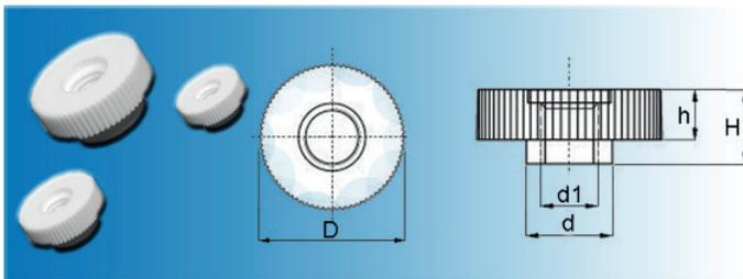
Nichtrostend, unempfindlich gegen Feuchtigkeit, Dampf und Seewasser. Elektrisch isolierend, beständig gegen Kriechstrom. Große mechanische Festigkeit, bis 600 kg/cm<sup>2</sup>. Frost- und hitzebeständig: -30°C bis +120°C.
