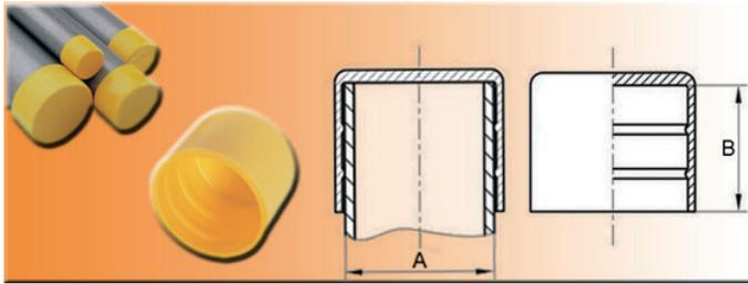
Die montagefreundlichen Kappen bieten einen Komplettschutz für Rohre ohne Gewinde. Sie schützen Rohrkanten, Innen- und Außengewinde. Minimieren Rostbildung und Verschmutzung. Die Innenrippen geben zusätzlichen Halt und ermöglichen das Entweichen von Luftdruck.
