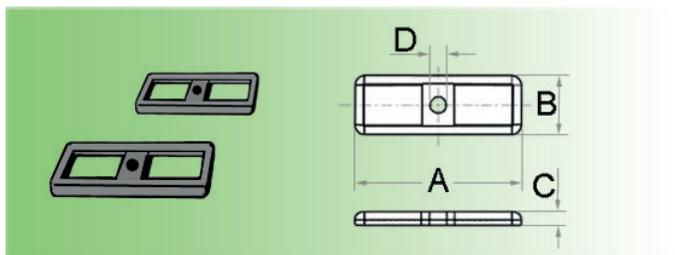
Verbindungsstück für Kabelschellen Serie 012
