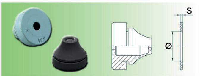
Diese Tüllen dienen dazu, eine staub- und wasserdichte Abdichtung zu schaffen. Die Ausführung der Tülle ermöglicht den Gebrauch als Blindstopfen, bis die Kabelinstallation erforderlich ist. Besonders geeignet für den externen Gebrauch. Bei korrekter Montage entspricht die Tüllendichte der Norm IP67. Diese Tüllen lassen sich mühelos und schnell einbauen.
