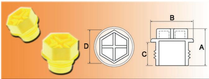
Schraubstopfen mit kurzem, metrischen Gewinde zum schnellen Ein- und Ausbau. Montage und Demontage mit einem Schraubendreher, Schraubenschlüssel oder Steckschlüssel von Hand oder mit einem Elektrowerkzeug möglich.
