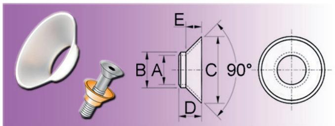
Verhindert elektrolytische Korrosion bei Schrauben mit versenkten Köpfen. Vielfach verwendet in der Beleuchtungs- und elektrotechnischen Industrie. Dieses Isolierelement ist bereits in vielen Ländern gesetzlich vorgeschrieben. Außerdem eine gute Sicherung von Senkkopfschrauben und dämpft Schwingungen.
