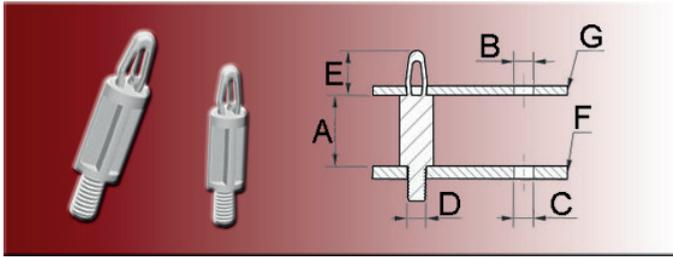
An einer Seite mit Gewinde M4 versehen für die Befestigung mit einer Mutter.
